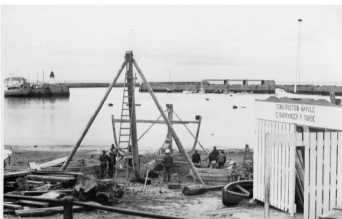
Devant le chantier Barranger, la pose du "maître bau" sur l'étrave d'un thonier. Coll. Barranger
