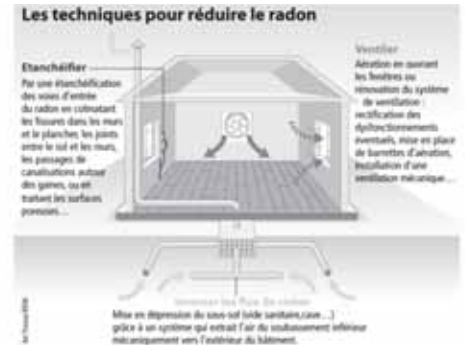
Technique de réduction du radon (source : IRSN)
