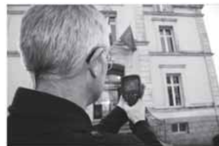
Une caméra thermique permettra de visualiser les ponts thermiques (Crédit : Elise)
